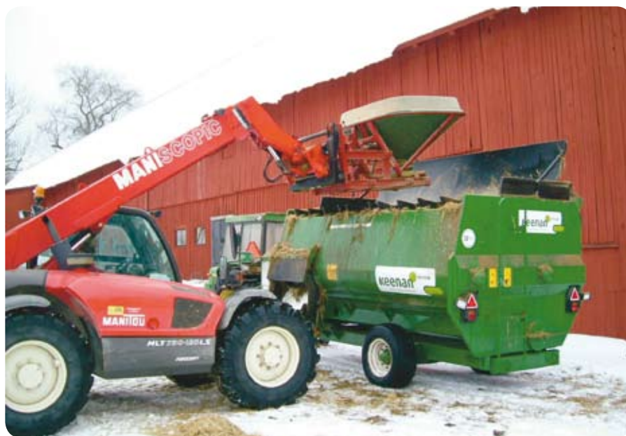
På Hornsund har man byggt om en gammal konstgödselspridare till proteindoserare. Man använder AAT-balans från Svenska foder. Med ett hydrauliskt spjäll doserar man i rätt mängd proteinkoncentrat för varje mix, vagnens våg syns från lastmaskinen. Foto: C-G Mörner.
