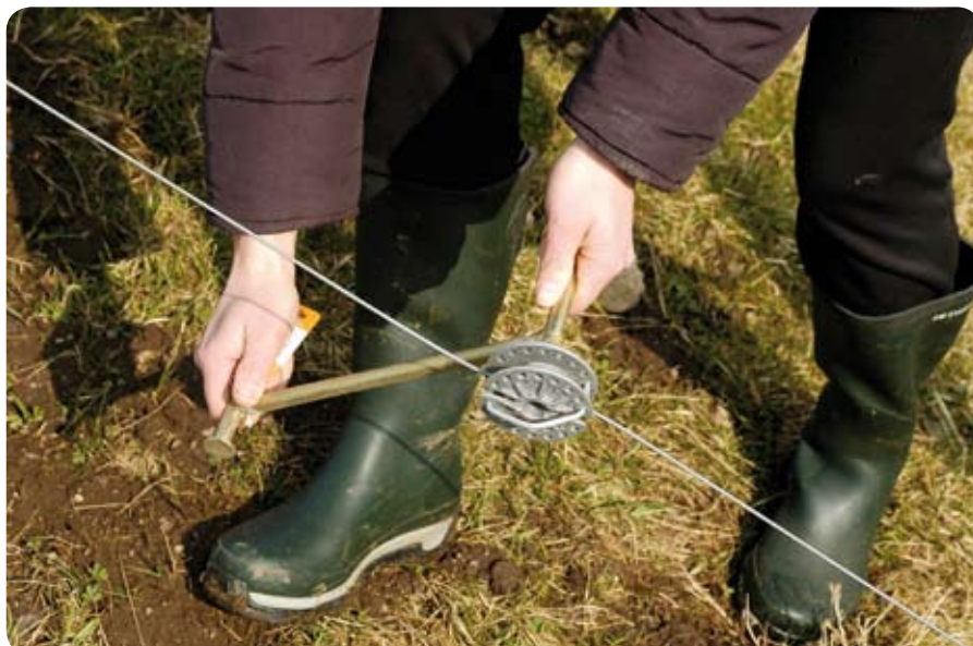
En spännrulle är ett mycket effektivt hjälpmedel för att spänna trådar över långa sträckor. Det är också lätt att släppa spänningen på tråden, värdefullt vid framtida reparationer.
